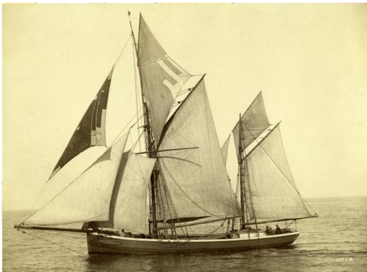
En djupt lastat, troligen fransk, galeas kring förra sekelskiftet. Fartyget har flygande bredfockrå med brassarna till bogsprötsnocken för att ej slita storseglet när dess skot är avfirat vid god vind. Märk även mesanstageglet, halsat i lovarts storvant. Skotet är en enkel sejsing som den ene av männen håller i ena handen, i den andra håller han fallet. Seglet är ett "save-all" av det slag som sjömannen älskar att leka med, då som nu.
